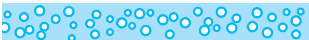
ETERNAL IN Thermo po nanesení na stěnu. V této fázi „plavou“ mikrokuličky v nátěrové hmotě.
