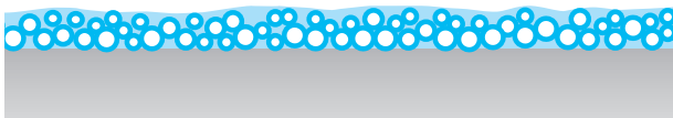
ETERNAL IN Thermo po zaschnutí. Kuličky pevně doléhají jedna na druhou, a tím tvoří bariéru proti prostupu tepla.
